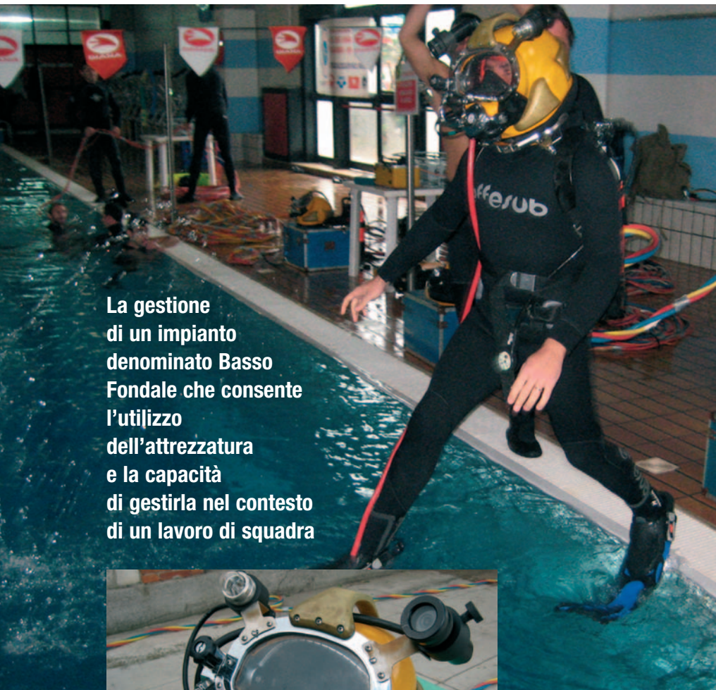
Kirby Morgan. Sono due i caschi rigidi utilizzati durante l'esercitazione: il 17b classico destinato all'operatore in immersione e il 18b destinato all'operatore in stand by
